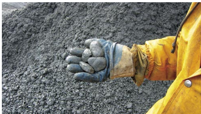
Fig.2. Polska, Gniew – separacja urobku na sitach; Długość otworu: 650 m; Rurociąg stalowy DN 800; Długość sekcji żwirowo-kamienistej 210 m; Siła ciągnięcia: 70 T.
